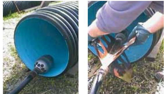
Prove di abrasione per mezzo di sonde.
